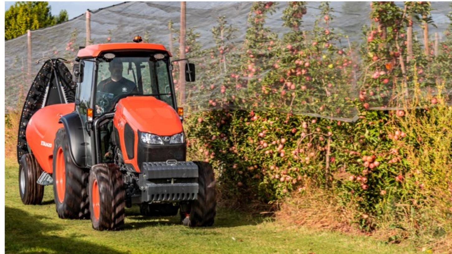
Le pont avant à engrenage conique offre un angle de braquage étonnant de 55° et une agilité unique pour le M5002N. Cela rend le tracteur idéal pour les travaux dans les espaces restreints. Cela fait maintenant plus de 30 ans que Kubota utilise le système du pont avant à engrenages coniques. Pour de bonnes raisons, puisqu'en plus d'une maniabilité exceptionnelle ce système offre une garde au sol plus élevée et un entretien limité avec un seul point de graisseur de chaque côté.
