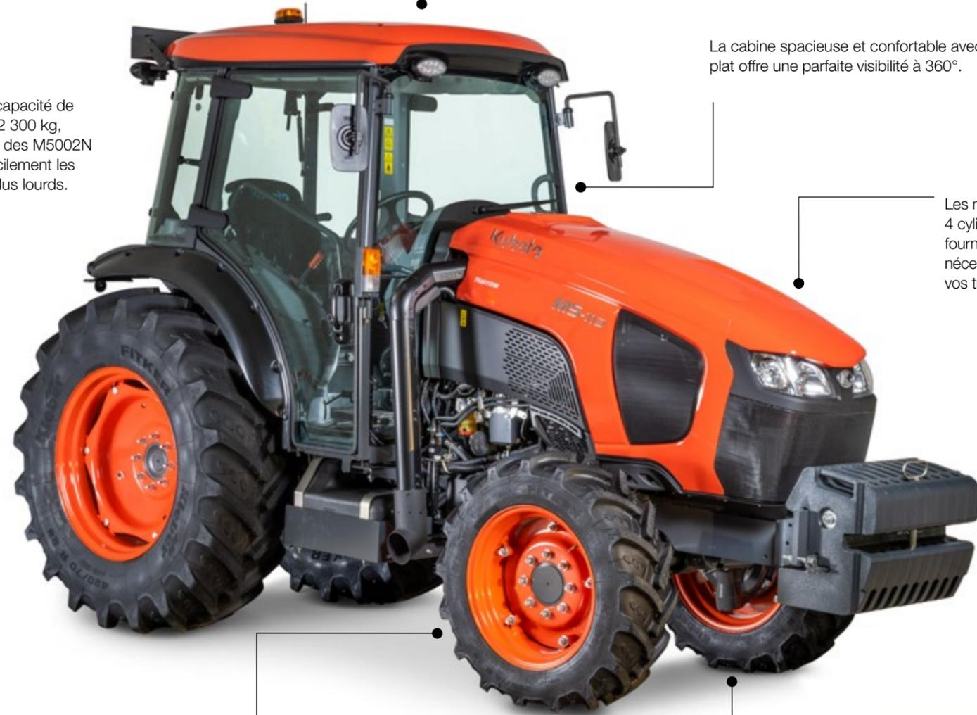
En option est disponible la cabine Cat 4 pour une protection maximale de l'opérateur lors des travaux de traitement. En effet ce kit de filtration permet de retenir toutes les poussières, aérosols et vapeurs pour un air sain dans la cabine.
