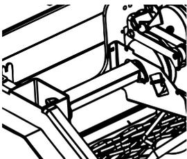
Pour démonter ce carter de protection, on dévisse les 4 écrous qui fixent le carter de protection.
