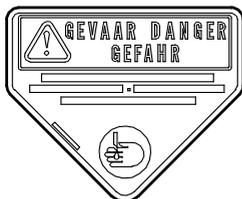
Cet autocollant se situe du côté gauche de la colonne, à proximité des herses. L'autocollant avertit du danger de coupures au cas où les mains ou d'autres membres se trouvent à proximité de la zone renseignée.
