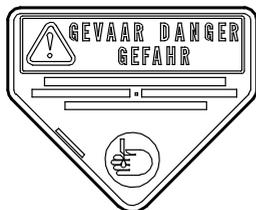
Cet autocollant est également collé sur la garde. L'autocollant avertit du danger de coupures au cas où les mains ou d'autres membres se trouvent à proximité de la zone renseignée.
