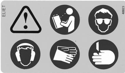
Cet autocollant est collé sur la face supérieure de la carrosserie. Il s'agit d'un endroit central sur la machine qui est toujours bien visible pour l'opérateur.
