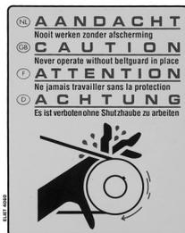
Un autocollant de sécurité est collé sur la face intérieure de la garde et précise que le travail ne peut être exécuté sans cette garde. Le danger est grand que les vêtements ou des membres puissent être coincés dans l'entraînement et être déchirés.
