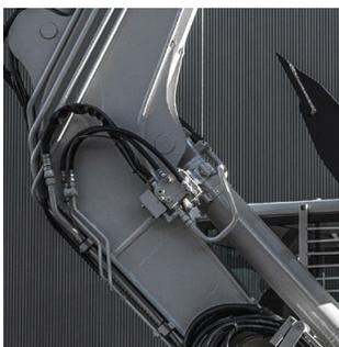
Protection contre la rupture de flexible
